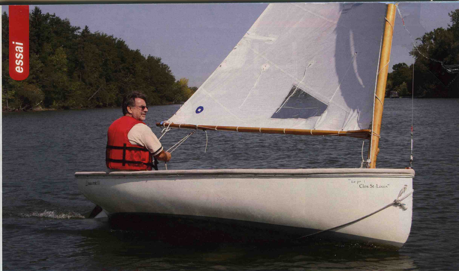
Louis Ducharme en train de tirer des bords sur son Bras d'Or 11 sur la rivière Richelieu devant l'île de Jeannotte. Remarquez le bourrelet textile qui ceinture le livet pour absorber les chocs à l'accostage.
